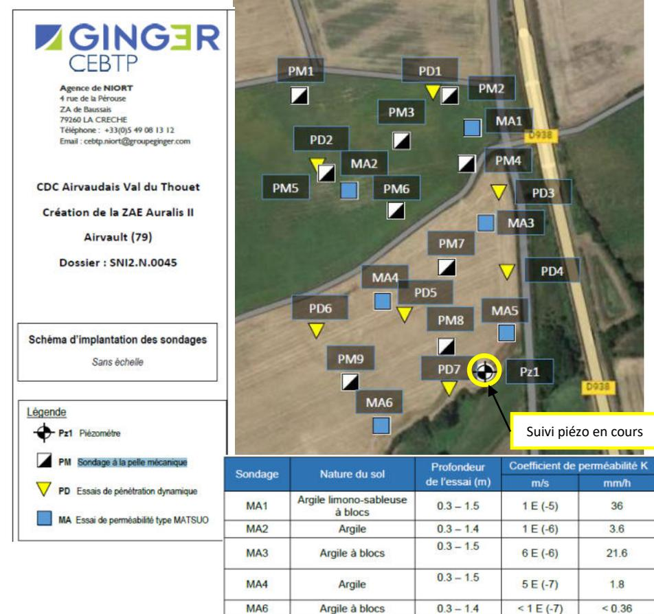
En complément, **2 tests de type « Porchet » ont été réalisés sur l'horizon supérieur** (~ 40 cm de profondeur). **La perméabilité mesurée est de 15 mm/h correspondant à des sols moyennement perméables** (mesure oscillant entre 17 et 22 mm/h après saturation de 4 heures),).
